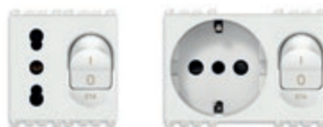
19273.B Bpresa 16 A P17/11 250 V~, 1P+N C 16 - 2 modules 19276.B 16 A P30 250 V~, 1P+N C 16 - 3 modules
